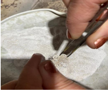
Görsel 9 (Toz halindeki boraksın iç dolguya serpilmesi)
