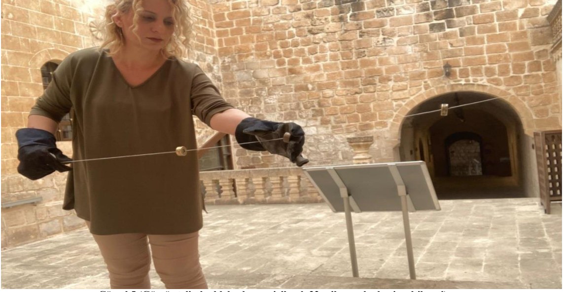
Görsel 5 (Gümüş telin haddelerden geçirilerek 22 mikrona kadar inceltilmesi)
