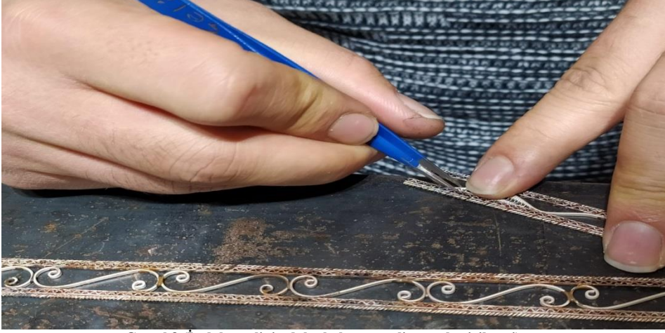
Görsel 8 (İç dolgu telinin daha kalın çatı teline yerleştirilmesi)
