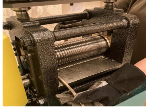
Görsel 4 (Çubuk gümüşün silindir makinesinden geçirilmesi)
