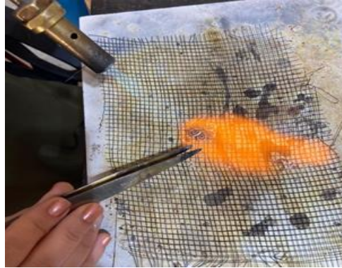
Görsel 10 (İç dolgu ve çatı telinin kaynak yapılması)
