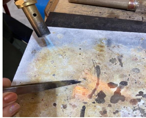
Görsel 7 (Çatı telinin şalimoyla ısıtılması)
