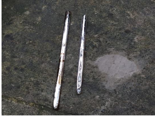
Görsel 3 (Çubuk haline gelen eritilmiş gümüş)
