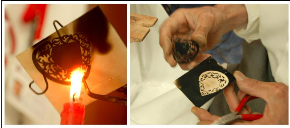
Resim 13: Yaylı çift ve ataçla tutturulmuş ajurlu kalıbın, işleme yöntemi ile gümüş levhaya aktarılması (15.07.2009)
