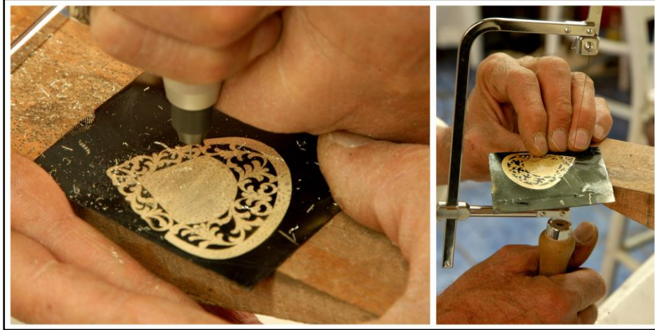
Resim 15: İs yardımı ile deseni aktarılmış gümüş levhanın freze ile delinip, kıl testereyle kesilerek delik işi (ajurlaşma) yapılması (15.07.2009)
