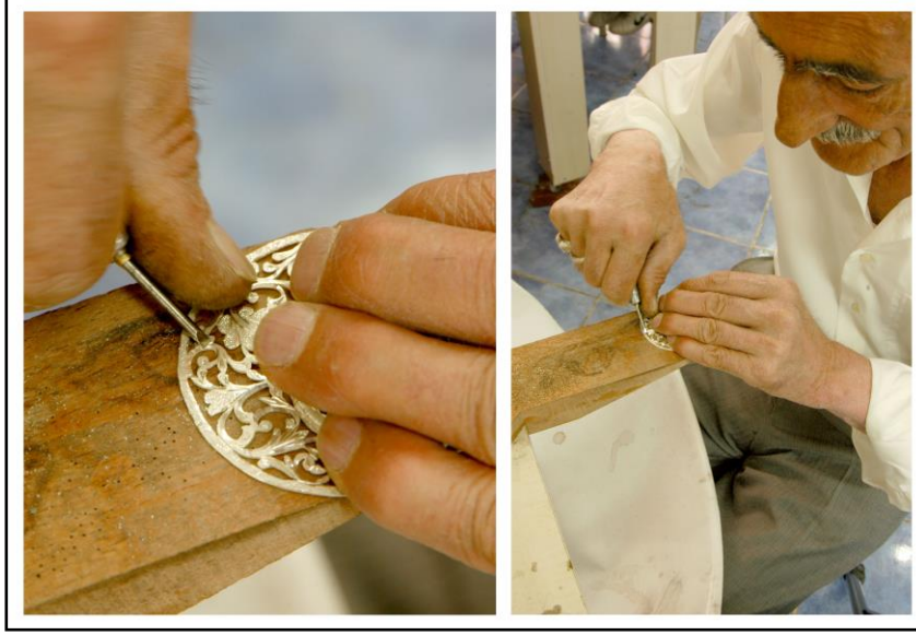
Resim 16: Kesme işlemi tamamlanmış ajurlu takıya kalem atma işlemi yapılırken (15.07.2009)
