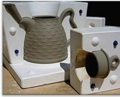
Resim 5. Alçı kalıba döküm yöntemi ile şekillendirilmiş demlik.
