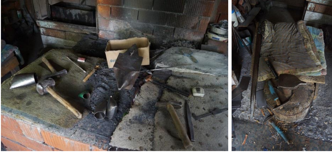
Resim 18-19. Çan imalatında kullanılan aletler- Mehmet Küçükçancı atölyesi (Foto: Mahmut Davulcu Arşivi)
