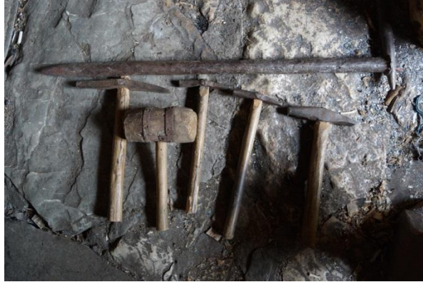
Resim 16. Çan imalatında kullanılan aletler-Halil Küçükçancı atölyesi (Foto: Mahmut Davulcu Arşivi)
