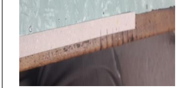
Görsel 20: Dikiş makinesine atılan çentikler ile yapılan mukavva tela numaralandırma işlemi
