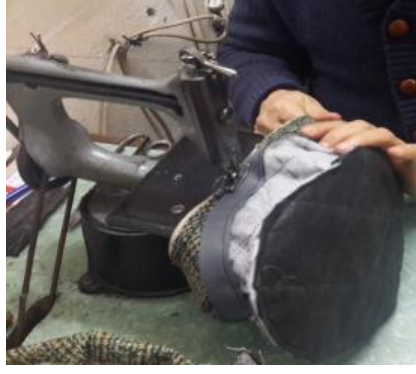
Görsel 29: Astar ile çatının dikilmesi
