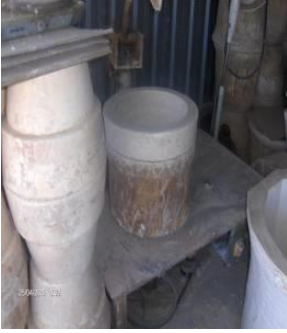
Resim 5. Alçı kalıbın şablona oturtulması
