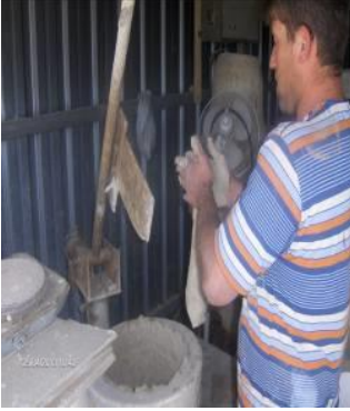
Resim 7. Saksı formunun ağız kısmının oluşturulması
