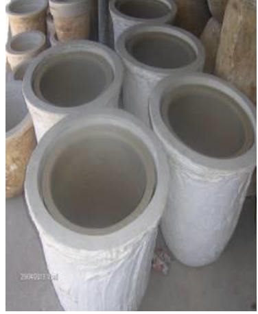
Resim 10. Saksı formunun alçı kalıplarda kurutulması
