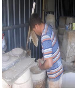
Resim 6. Ürünün tabanının kalıba yerleştirilmesi
