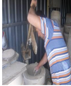
Resim 8. Şablonda saksı formunun düzeltilmesi
